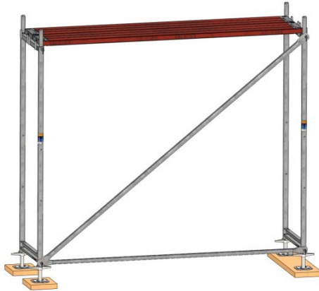
Bild 15: Systembeläge in die Zapfen eingehängt
