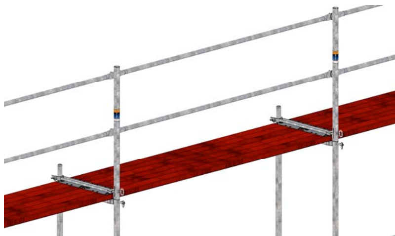
Bild 45: Oberer Abschluss mit Geländerpfosten und Belagsicherungen.
